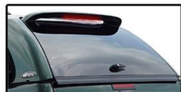
Spoiler arrière avec 3ème feu stop.
